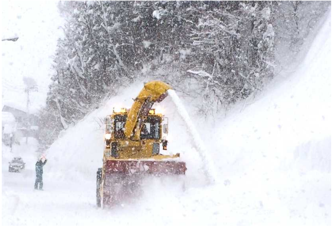
車両を止めて行う道路除雪（長野県）
